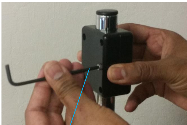
Dotáhněte inbusovým klíčem
