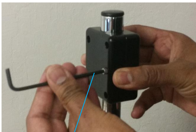
Притягане с шестостенен ключ
