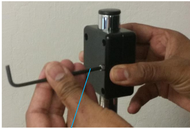
Serrer à l'aide de la clé Allen
